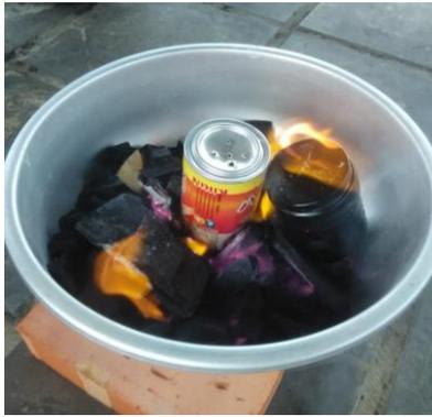
蒐集小型鐵製容器，將其內部以奇異筆或油漆塗黑，將欲碳化之原料放入鐵罐中，密封後於上開幾個小洞，使有機化學氣體可以逸出，最後置於火源上加熱
