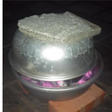
將火源加上蓋子，使其悶燒提高溫度，並持續壓入火原，觀察是否冒出白煙，待白煙不再冒出後，將鐵罐取出降溫，檢查原料是否已經碳化。
